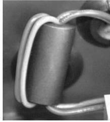
**Figura 3-2: Núcleo de ferrite e condutores de alimentação**
