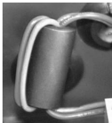
Figura 3-2: Núcleo de ferrita y cableado de alimentación
