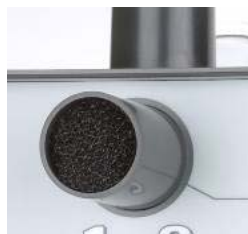
Figura 4-3: Filtro en la entrada del Detector AutoSAT 20
