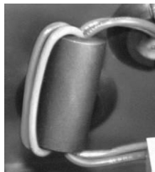
Figura 3-2: Núcleo de ferrite e condutores de alimentação
