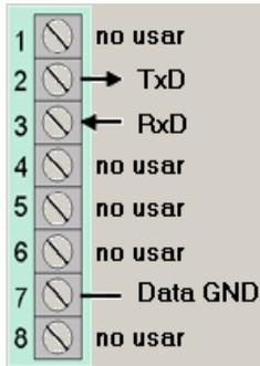
Módulo de conexión en serie RS232 o TTY para el intercambio de datos con dispositivos externos.
