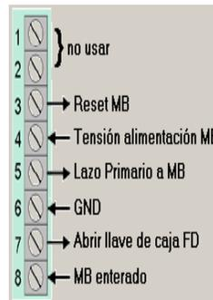
Micromódulo para la conexión de la Master Box para aviso al Cuerpo de Bomberos
