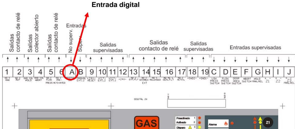
La central tiene una entrada digital para contacto externo programable, con el fin de controlar el panel desde otro sistema superior externo.
