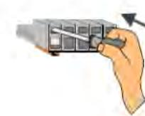
Terminal liberación de cable. Presione en la parte superior y encaje el cable en la inferior.
