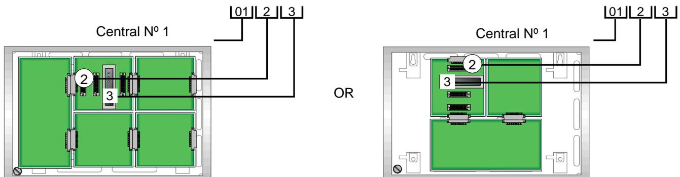
Fig. 628: Ejemplo de N° de módulo o lazo en central FlexES Control (Formato horizontal y vertical)
