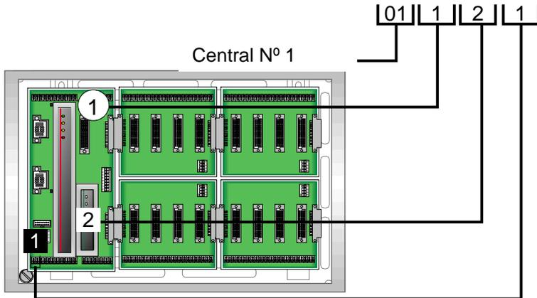
Fig.69: Ejemplo de puerto de comunicaciones número 1 de placa base / Módulo de control (CPU)
