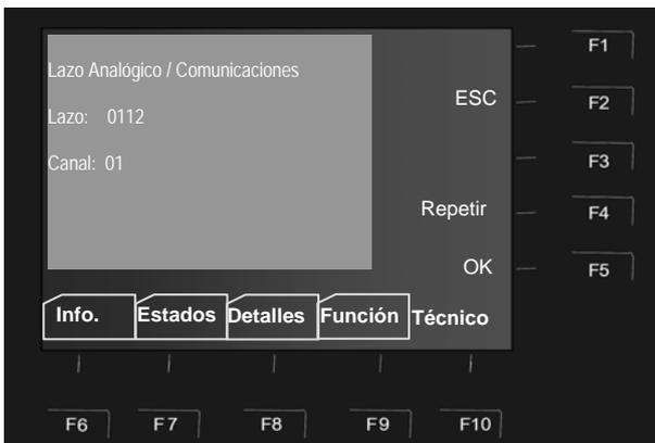
Fig. 630: Lazo analógico / comunicaciones nº 0112 canal 1 (ejemplo)
