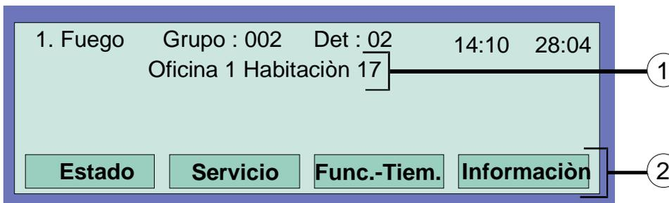
Fig. 35: Visor de uma mensagem de estado detalhado de alarme de incêndios (exemplo)
