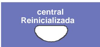
Cancelam-se todos os alarmes de incêndios detectados, visualizações e sinais de alarme técnico (alarme TAL) e voltam à condição normal.
