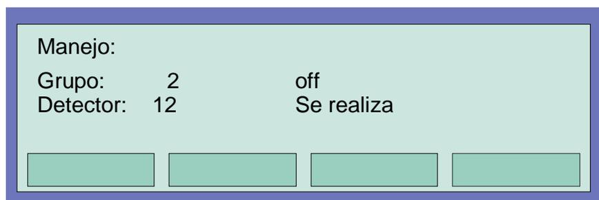
Fig. 25: Visor de desligar do Grupo de detectores 2 / detectores 12
