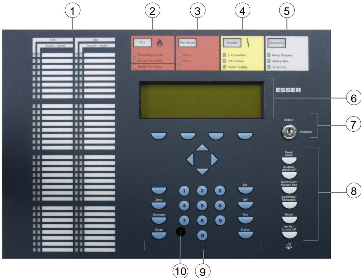
Fig. 1: Visão geral do display e elementos operativos
