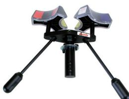
Elemento con tres semicircunferencias intercambiables para detectores con diámetro entre 55 y 105mm. La cabeza es basculante para poder acceder al detector desde cualquier ángulo respecto a la vertical o bien se puede mantener fija para su uso en posición recta.
