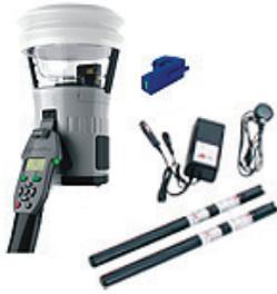
Cabeza de comprobación de detectores con dosificador de humo y calefactor, controlado por microprocesador. Permite seleccionar el orden de prueba y realizar el barrido de la cámara de los detectores con aire. Leds indicadores de funcionamiento de modo de prueba (humo, calor o limpieza) fallo y batería baja. Dispone de cartucho de pruebas con humo concentrado para generar la correcta dosificación para el test. Incluye batería de reserva y cargador para alimentación o coche.
