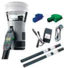
Cabeza de comprobación de detectores con dosificador de humo, CO y calefactor, controlado por microprocesador. Permite seleccionar el orden de prueba y realizar el barrido de la cámara de los detectores con aire. Leds indicadores de funcionamiento de modo de prueba (humo, CO, calor o limpieza) fallo y batería baja. Dispone de cartucho de pruebas con humo concentrado y de CO para generar la correcta dosificación para el test. Incluye batería de reserva y cargador para alimentación o coche.
