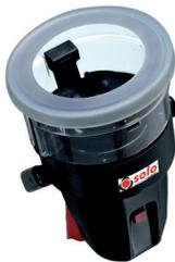
Cabeza generadora de calor transparente que permite ver los leds de disparo para comprobar el funcionamiento de los detectores de temperatura de hasta 90°C/194°F. El calefactor se activa mediante célula infrarroja. Protección de corte de batería a los 120 segundos, rearme a los 5 minutos. Alimentada por baterías recargables que se acoplan entre la cabeza y la pértiga extensible SOLO-100. Autonomía para 50 pruebas de 30 segundos.
