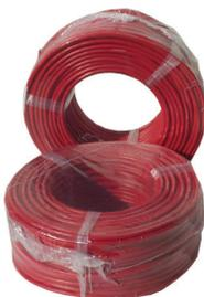
Bobina de cable de manguera de par trenzado y apantallado. De color rojo y cobre pulido flexible, clase V de 2x1,5mm<sup>2</sup>. Pantalla con cinta de aluminio/poliéster y drenaje de cobre estañado de 0,5mm<sup>2</sup>.
