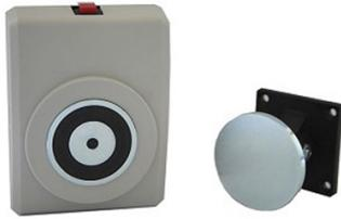
Retenedor de pared de 850N con caja y pulsador, para puerta cortafuego. Caja de plástico reforzado con fibra y pulsador de desbloqueo rojo. El equipo libera la puerta cuando se deja de aplicar la tensión de 24 Vcc. Incluye diodo de protección y polarización y placa ferromagnética articulada Ref. 960114.
