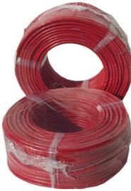
Cable de manguera de par trenzado y apantallado. De color rojo y cobre pulido flexible, clase V de 2x1,5mm<sup>2</sup>. Pantalla con cinta de aluminio/poliéster y drenaje de cobre estañado de 0,5mm<sup>2</sup>. No propagador de llama, libre de halógenos, baja emisión de humo y baja corrosividad.
