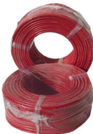
Cable de manguera de par trenzado y apantallado. De color rojo y cobre pulido flexible, clase V de 2x2,5mm<sup>2</sup>. Pantalla con cinta de aluminio/poliéster y drenaje de cobre estañado de 0,5mm<sup>2</sup>. No propagador de llama, libre de halógenos, baja emisión de humo y baja corrosividad.
