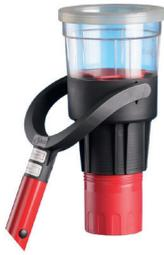
Cabeza difusora transparente que permite ver los leds de comprobación del funcionamiento de los detectores de humo. Se acciona a través de una ligera presión contra el techo. Dispone de alojamiento ajustable para el envase de gas de pruebas SOLO-A3. La cabeza es basculante para poder acceder al detector desde cualquier ángulo respecto a la vertical.
