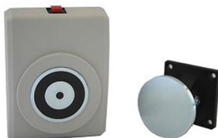
Retenedor de pared de 400N con caja y pulsador, para puerta cortafuego. Caja de plástico reforzado con fibra y pulsador de desbloqueo rojo. El equipo libera la puerta cuando se deja de aplicar la tensión de 24 Vcc. Incluye diodo de protección y polarización y placa ferromagnética articulada Ref. 960110.
