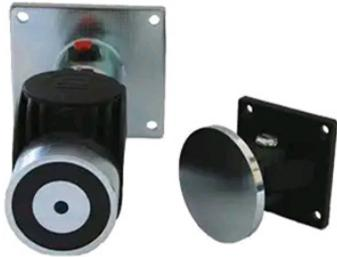
Retenedor de pared de 400N, con soporte abatible a 90° (150 mm) para suelo o 180° (175 mm) para pared. Cabeza giratoria de plástico reforzado con fibra de vidrio y pulsador de desbloqueo rojo. El equipo libera la puerta cuando se deja de aplicar la tensión de 24 Vcc. Incluye diodo de protección y polarización y placa ferromagnética articulada Ref. 960110.
