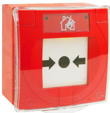
Pulsador compacto Ex (i) IQ8 IP66/67 con tapa protectora. Requiere la barrera Ex 804744 para su conexión directa al lazo Esserbus. Clasificación Ex ib IIC T4 Gb.
