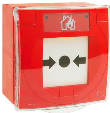
Pulsador compacto Ex (i) convencional IP66/67 con tapa protectora. Requiere la barrera Ex (764744) para su conexión a transponder. Clasificación Ex ib IIC T4 Gb.
