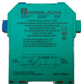
Aislador galvánico. Permite conectar 1 sirena convencional de seguridad intrínseca IS-MA1 EEX ia. El aislador galvánico se debe montar en una zona segura fuera del área de riesgo.
