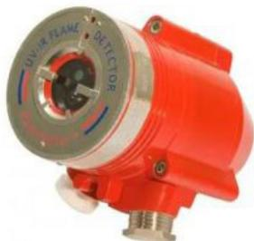
Detector de llama UV (ultravioleta) e IR (Infrarrojo) en carcasa de aluminio con certificado CPD EN54/10 y SIL2. Detecta fuegos de combustibles a base de hidrocarburos, hidróxido e hidrógeno y metales o materia inorgánica. Incorpora microprocesador para analizar la señal de las llamas, múltiples niveles de alarma ajustables. Montado en carcasa de aluminio antideflagrante. Dispone de salida de relé de alarma, avería y relé auxiliar NA. Con rosca NPT.
