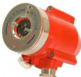
Detector de llama IR (infrarrojo) en carcasa de aluminio con certificado CPD EN54/10 y SIL2. Incorpora un microprocesador para analizar la señal de las llamas, con múltiples niveles de alarma ajustables y prueba manual. Detecta fuegos de combustibles de hidrocarburo y fuegos de gas mediante un sistema avanzado de análisis de llama. Dispone de salida de relé de alarma, avería y relé auxiliar NA. Con rosca NPT.
