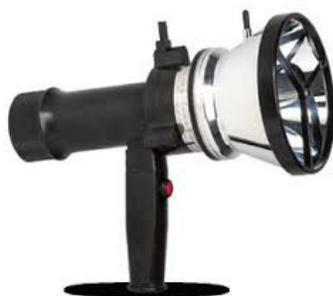
Maletín de pruebas que incluye un simulador de llama ATEX/IECEx para uso en Zona 1 y Zona 21. Alineamiento fácil con puntero láser y distancia de prueba de 12 m (según sensibilidad y tipo de detector). Incluye carcasa antideflagrante con batería para 1.000 test, cargador y maleta para comprobar los detectores de llama SPECTREX IR3 y Multi-IR.
