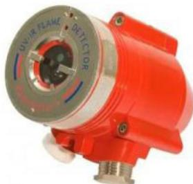
Detector de llama UV (ultravioleta) en carcasa de aluminio con certificado CPD EN54/10 y SIL2. Incorpora un microprocesador para analizar la señal de las llamas, con múltiples niveles de alarma ajustables y prueba manual. Dispone de salida de relé de alarma, avería y relé auxiliar NA. Con rosca NPT.
