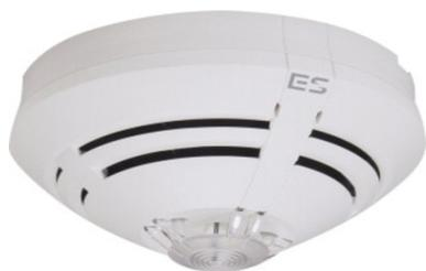
Detector multisensorial óptico-térmico con luz azul de la serie ES Detect. Provisto de un microprocesador individual para el funcionamiento en sistemas convencionales de inteligencia distribuida. Dispone de función de aclimatación, autocomprobación y algoritmos de patrón de fuego. Especificación EN54-7 y EN54-5 A2.
