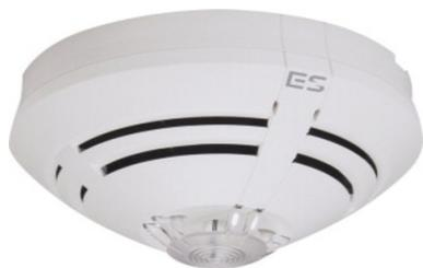
Detector óptico de humos convencional de la serie ES Detect. Provisto de un microprocesador individual para el funcionamiento en sistemas convencionales de inteligencia distribuida. Dispone de función de aclimatación, autocomprobación y algoritmos de patrón de fuego. Especificación EN54-7.
