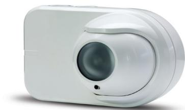
Receptor OSID 80° para hasta 7 emisores y distancias de 6m hasta 36m usando emisores de potencia estándar y de 12m a 68m con emisores de alta potencia OSE-HPW o 50m con los OSE-HP-01
