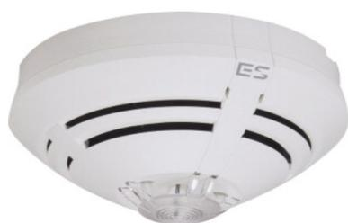
Detector temperatura fija convencional de la serie ES Detect. Provisto de un microprocesador individual para el funcionamiento en sistemas convencionales de inteligencia distribuida. Dispone de función de aclimatación, autocomprobación y algoritmos de patrón de fuego. Especificación EN54-5 A1S.
