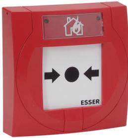
Pulsador de alarma de incendios convencional diseño compacto. Incorpora botón de accionamiento y LED rojo de indicación de alarma. Serigrafía impresa según EN54-11 con indicación de operación en caso de alarma.
