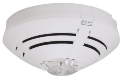
Detector termovelocimétrico convencional de la serie ES Detect. Provisto de un microprocesador individual para el funcionamiento en sistemas convencionales de inteligencia distribuida. Dispone de función de aclimatación, autocomprobación y algoritmos de patrón de fuego. Especificación EN54-5 A1R.
