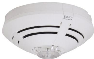
Detector multisensorial óptico-térmico de doble cámara óptica de la serie ES Detect. Provisto de un microprocesador individual para el funcionamiento en sistemas convencionales de inteligencia distribuida. Dispone de función de aclimatación, autocomprobación y algoritmos de patrón de fuego. Especificación EN54-7 y EN54-5 B.
