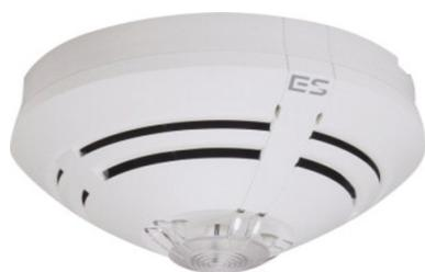
Detector alta temperatura convencional de la serie ES Detect. Provisto de un microprocesador individual para el funcionamiento en sistemas convencionales de inteligencia distribuida. Dispone de función de aclimatación, autocomprobación y algoritmos de patrón de fuego. Especificación EN54-5 BS.
