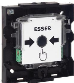
Módulo electrónico de pulsador de alarma de incendios convencional diseño grande. Incorpora botón de accionamiento, LED rojo de indicación de alarma y segundo contacto. Serigrafía impresa según EN 54-11 con indicación de operación en caso de alarma. En combinación con la carcasa amarilla 704902, el pulsador cumple con la norma EN 12094-3 para sistemas de extinción. Capacidad de corte del segundo contacto 30Vdc/1A
