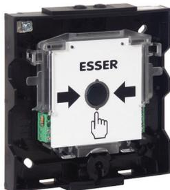
Módulo electrónico de pulsador de alarma de incendios convencional diseño modular. Incorpora botón de accionamiento y led rojo de indicación de alarma. Serigrafía impresa según EN54-11 con indicación de operación en caso de alarma. Caja de montaje no incluida. En combinación con la carcasa amarilla 704902 el pulsador cumple con la norma EN 12094-3 para sistemas de extinción.
