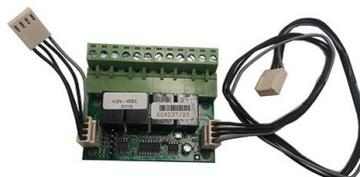
Tarjeta de 4 relés NA/NC para centrales convencionales ESS-RP1R-SUPRA. Cada relé se puede configurar de forma independiente y vincularse a las 12 matrices configurables de activación. Se instala en el interior de la central.
