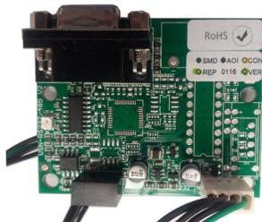
Tarjeta con un puerto de comunicaciones RS-232 para sistemas de control y gestión técnica o programas de gráficos de las centrales convencionales ESS-RP1R-SUPRA por puerto serie. Se instala en el interior de la central.
