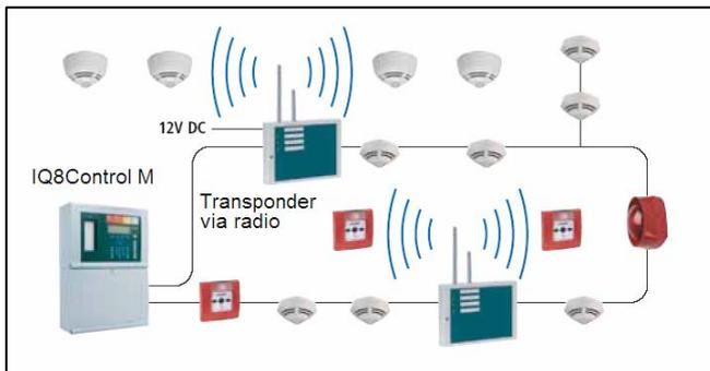
Cuando se conectan dispositivos vía radio a la central IQ8Control C, todos permanecen identificados individualmente y mantienen todas las características, tomando solo una única dirección. Para planificación y programación es necesario usar el software de puesta en marcha Tools 8000.
