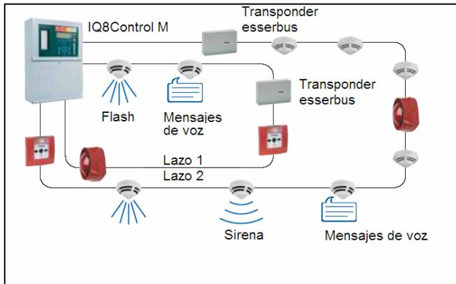
La alimentación de los dispositivos de alarma por el lazo esserbus junto con la capacidad de la central IQ8Control aseguran una integración óptima de los dispositivos de señalización ópticos y acústicos instalados en el lazo esserbus®. Así, la central IQ8Control C y los detectores IQ8Quad proporcionan una solución ideal y económica reduciendo al máximo los costes de instalación.
